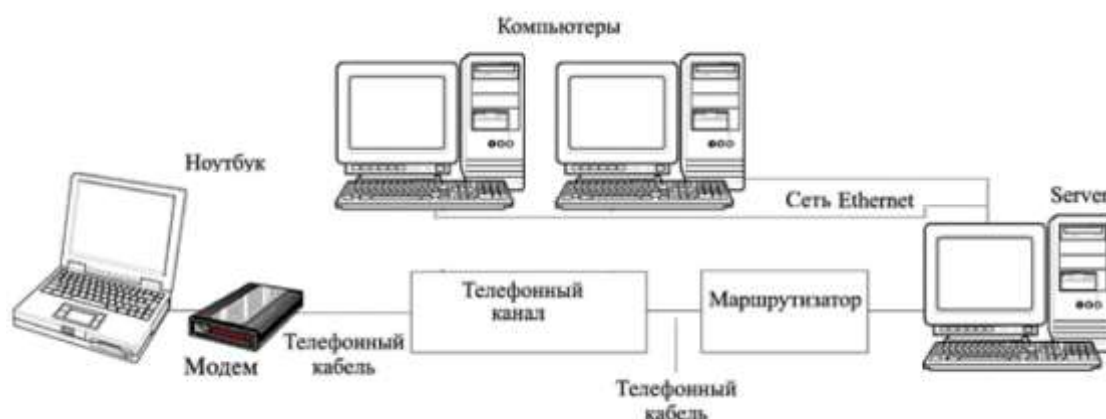
Рис. 16.1. Вариант связи ПК с удалённой ЛВС с помощью модема.
